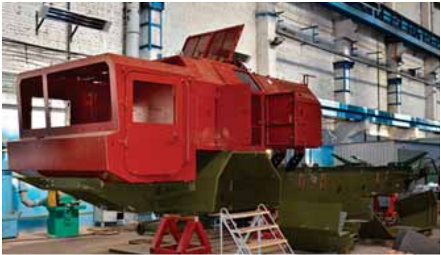
Складання першого прототипу шасі для розміщення оперативно-тактичного ракетного комплексу
