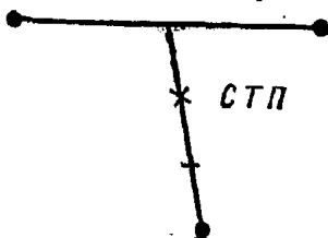
Мал. 52 Визначення середньої точки влучення по трьох пробойнах.
