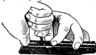
Мал. 19. Приєднання викидача до затвора.
