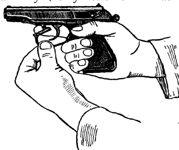
Мал. 4. Відтягування спускової скоби.
