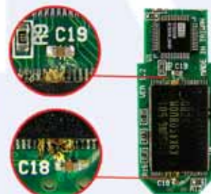
ФРАГМЕНТ ПЛАТИ FLASH- НАКОПИЧУВАЧА, ЯКИЙ ПОБУВАВ У ПРАЛЬНІЙ МАШИНІ
